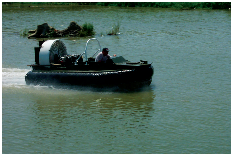
Șalupa de intervenție rapidă, pe pernă de aer, amfibie – experimentare sisteme de fustă flexibilă.
