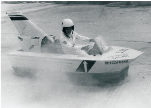
Modelul - 09E – motor „Mobra 68 cm3”
