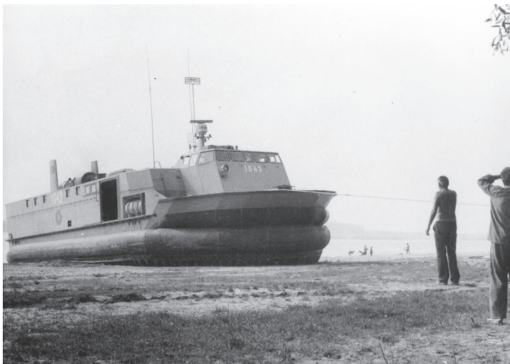
Nava pe pernă de aer amfibie – Desant Marin Proiect Ac 1043 probe de sustentaţie şi stabilitate
