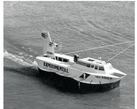
Model captiv 018E, motoare aeromodel pentru propulsie și sustentare - experimente pe lacul Brateș
