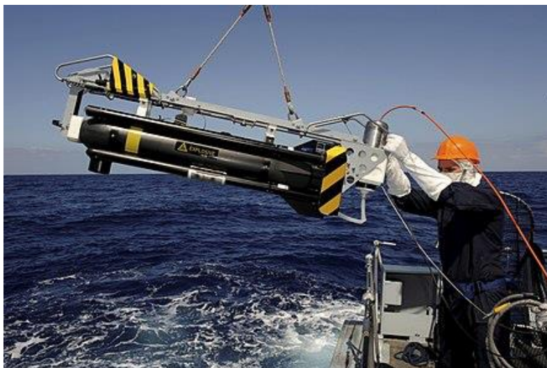
Fig.7. Drona Sea-Fox în proces de lansare la apă
